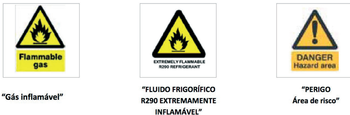
Figura 36: Alguns sinais de aviso que podem ser aplicados aos equipamentos e áreas de trabalho
